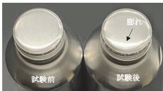
図10 リサイクル材適用キャップの耐圧試験前後の外観観察
