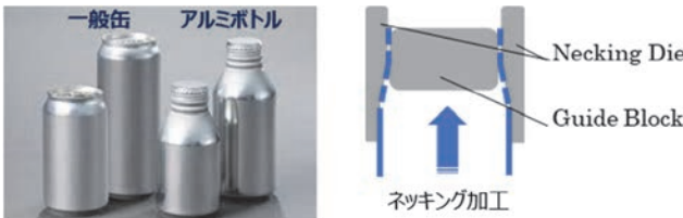
図1 アルミボトルのネック成形
