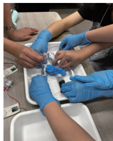
図1 備長炭バッテリー実験
