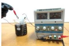
電気分解によってチタンの表面に被膜が作られ、電圧を変えると色が変化する不思議な実験を行います。
